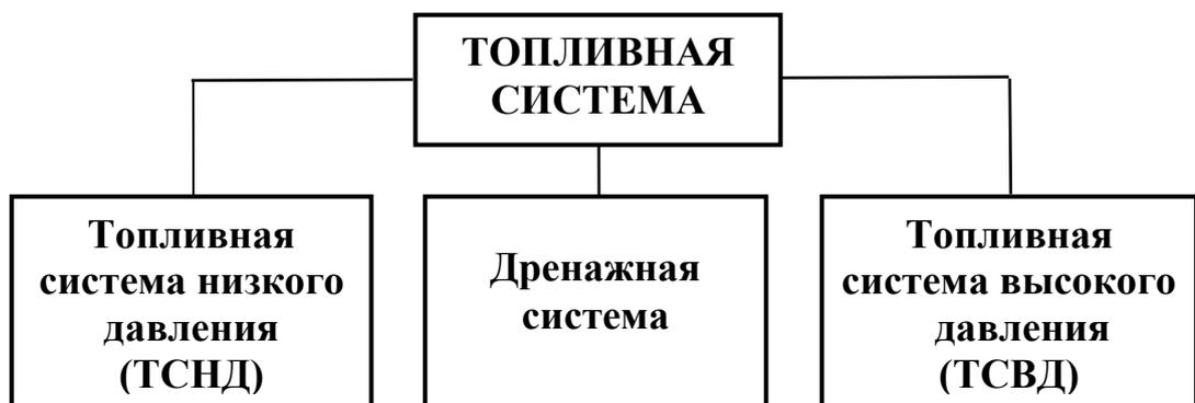
Рисунок 7.8 – Состав топливной системы дизеля
