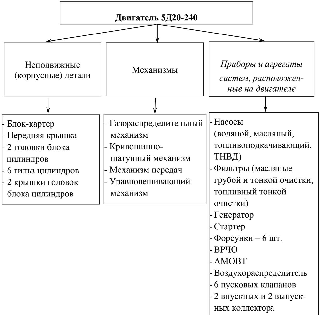
Рисунок 4.2 – Общее устройство двигателя 5Д20-240
