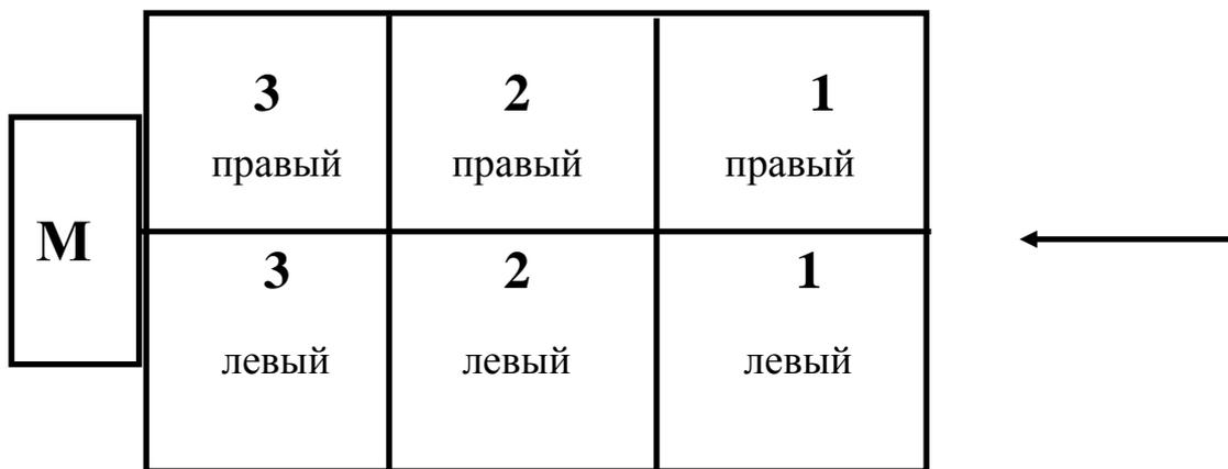
Рисунок 4.10 – Порядок работы цилиндров двигателя
