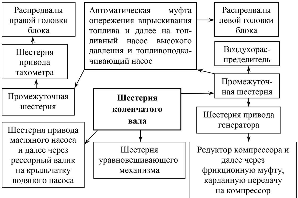
Рисунок 4.9 – Принципиальная схема работы механизма передач двигателя
