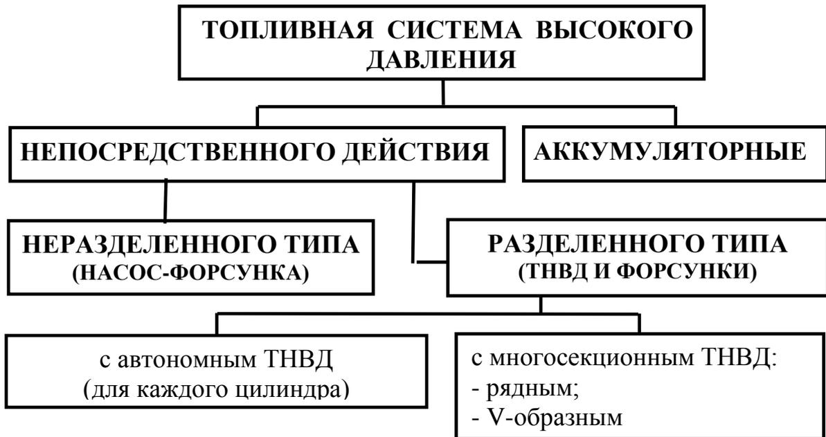
Рисунок 7.15 –Классификация топливных систем высокого давления
